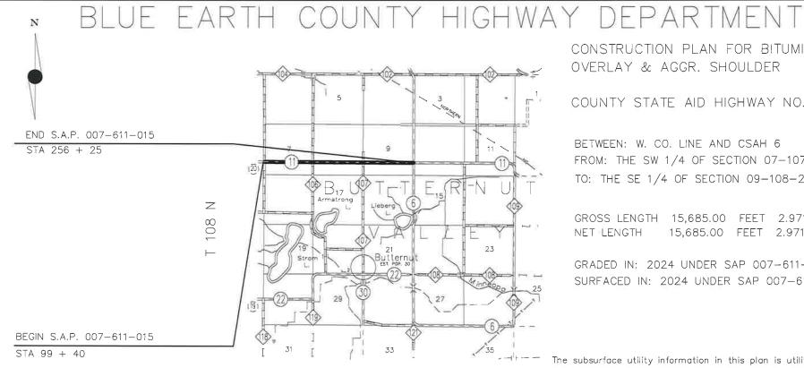
CONSTRUCTION PLAN FOR BITUMINOUS OVERLAY & AGGR. SHOULDER
